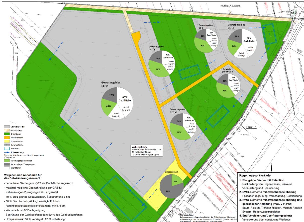
Abbildung 17: Regenwasserkonzept für das B-Plan-Gebiet mit Vorgaben und Annahmen zur Ermittlung der Flächenbedarfe der dezentralen Regenwasserbewirtschaftung und Darstellung der constructed Wetlands (maßstäblich)
