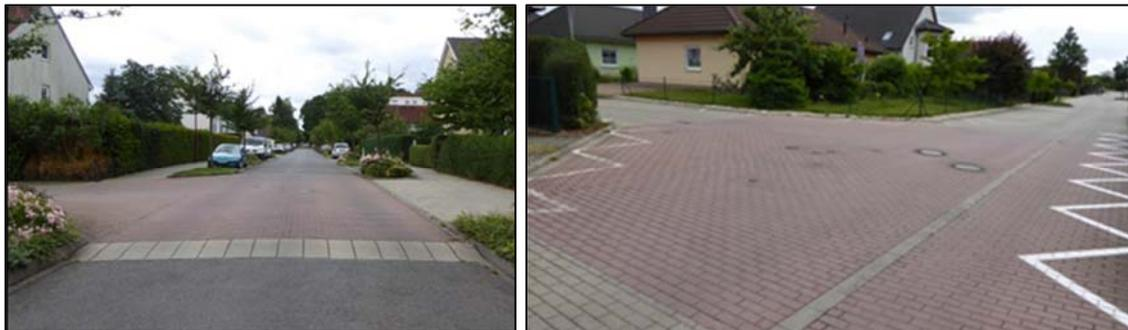
Abb. 41 Beispiele Aufpflasterung bzw. Oberflächendifferenzierung
